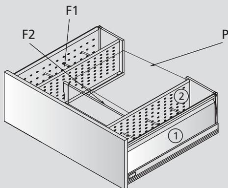
F1 - O comprimento equivale à largura interna entre o perfil dupla camada e o perfil de separação central menos 25 mm
